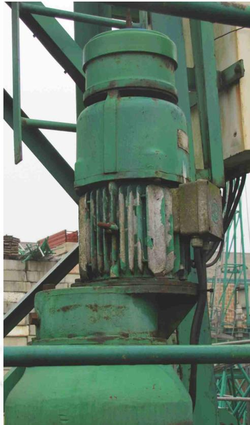
Motor de giro. ANTES *Slewing motor. BEFORE*
